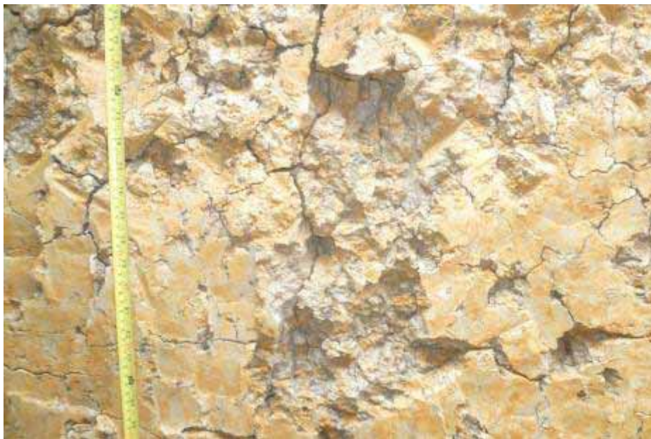
Photo 6 : Fentes de dessiccation apparues au bout de 5 jours.
