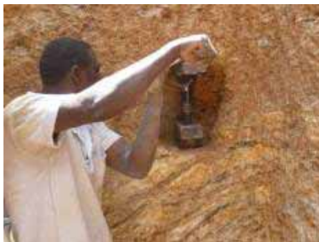
Photo 5 : Méthode de prélèvement de cylindres de densités.
