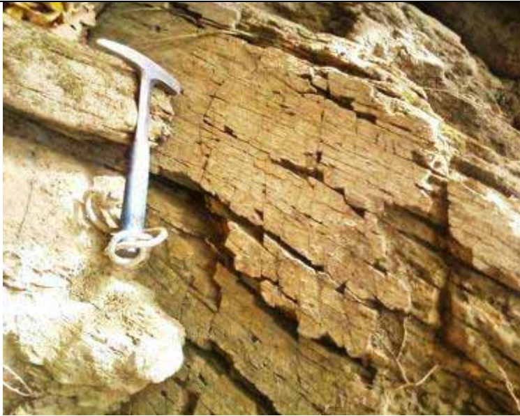
Photo 10 : Fracturation au sein des bancs de quartzites.
