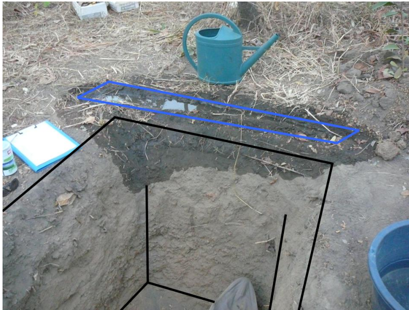
FIGURE 3.1 – Photographie d'une tranchée creusée proche d'une fosse de manipulation. Les lignes noires permettent de mieux comprendre la perspective de la photographie. Les lignes bleues indiquent l'emplacement de la rigole. L'humectation du sol est continue autour de la tranchée alimentée en eau. Il n'y a pas, en profondeur, de tâche d'humectation isolée qui traduirait un fonctionnement hydrodynamique rapide associé à de la macroporosité. Photographie : Jean-Pierre Vandervaere, 2011.
