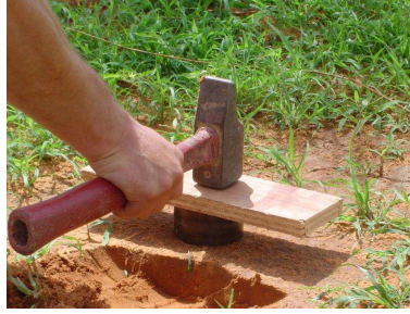
FIG. 6 – Prélèvement de sol pour établir les courbes caractéristiques avec les anneaux fournis par la Faculté Universitaire des Sciences Agronomiques de Gembloux. Sur cette photo, prélèvement en surface sur le site 17.
