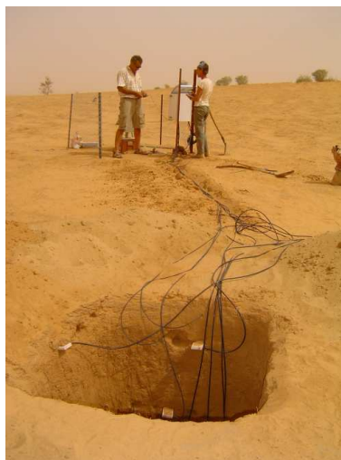
FIG. 3 – Fosse humidité du sol de Tin Zaket, avec 7 CS616 de la surface à 2.5m de profondeur, et 4 sondes températures.
