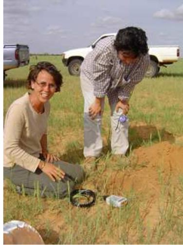
FIG. 1 – Mesures d’humidité du sol dans une fosse par gravimétrie et Théta probe.
