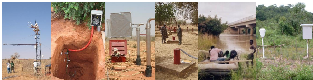
© IRD : station météorologique, sonde de mesure d'humidité du sol, têtes de prélèvements de poussières, piézomètre de mesure de la nappe phréatique, jaugeage de la rivière et pluviomètre : ces instruments et mesures jouent un rôle central dans l'observatoire AMMA-Catch.
