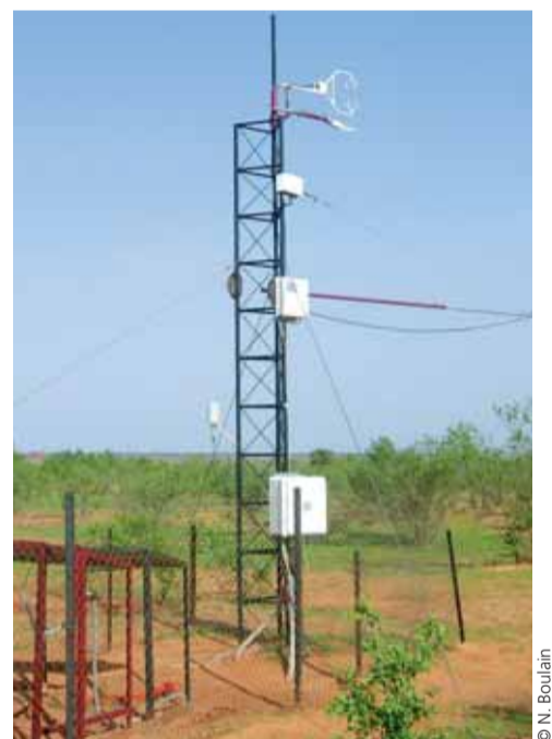
Mesure des flux turbulents et radiatifs sur jachère, Niger.
