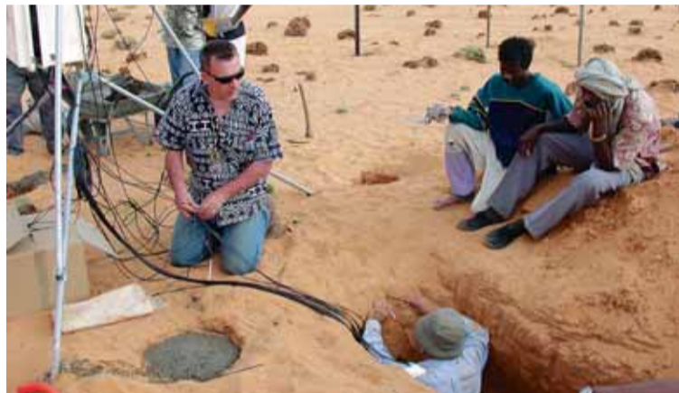
Implantation de la station bioclimatique localisée à 10 km au nord de Bamba (17,03°-Nord 1°24'-Ouest) en rive gauche du fleuve Niger. Enfouissement des capteurs d'humidité et de température du sol selon un profil vertical de 5 à 250 cm.
